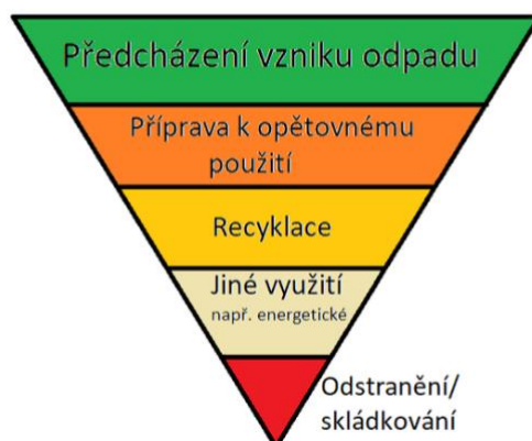
Obr. 14: Pyramida hierarchie správného nakládání s odpady. Zdroj: Komunální ekologie.
